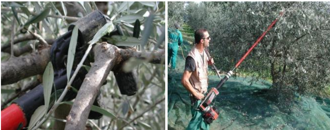
Εικόνα 101: δονητής με άγκιστρο
