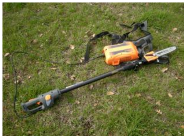
Εικόνα 89: ηλεκτρονικό αλυσοπρίονο τοποθετημένο σε τηλεσκοπικό πόλο με μπαταρία που μεταφέρεται σε ένα γιλέκο
