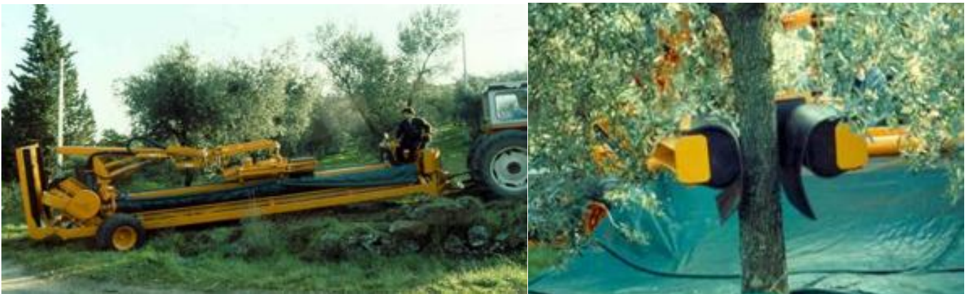
Εικόνα 109: Δονητής κορμού με υποδοχέα τοποθετημένο σε ελκυστήρα
