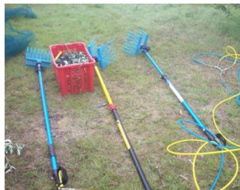
Εικόνα 99: χτένια που λειτουργούν με συμπιεσμένο αέρα
