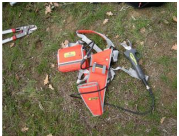
Εικόνα 88: ηλεκτρονικό ψαλίδι με μπαταρία
